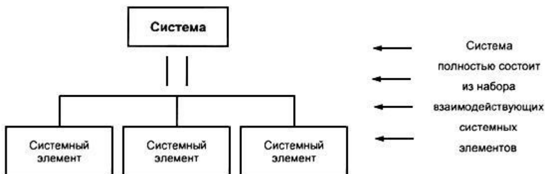
Рисунок D.2 - Взаимосвязь между системой и системными элементами
