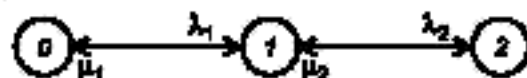
0 — состояние полного функционирования системы; 1 — ухудшенное состояние системы; 2 — неработоспособное состояние системы (состояние поглощения).
